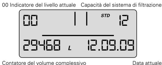
In questo livello viene gestito il contatore del volume complessivo che, indipendentemente dalle sostituzioni delle relative cartucce, conta in crescendo partendo da 0.
