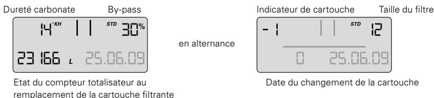
En haut à gauche s'affiche l'indicateur de la cartouche filtrante (-1 pour l'avant-dernière cartouche) en alternance avec la dureté carbonate réglée et en combinaison avec l'unité de dureté. En haut à droite s'affiche la taille du système de filtration en alternance avec le réglage by-pass (représentation indicateur 1 s, dureté carbonate 1 s), en bas à gauche l'état du compteur au remplacement de la cartouche (-1) et en bas à droite la date du changement de la cartouche.
