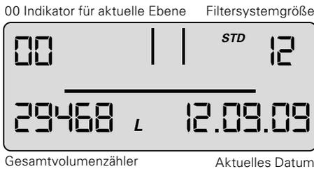
In dieser Ebene wird der Gesamtvolumenzähler geführt, der unabhängig von den jeweiligen Kartuschenwechseln von 0 beginnend hochzählt.
