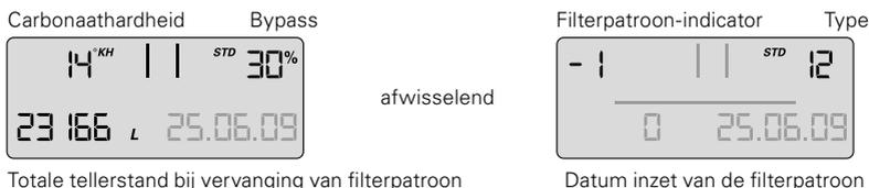
Linksboven wordt de indicator voor de filterpatroon (-1 voor de op één na laatste filterpatroon) afwisselend met de hierbij ingestelde carbonaathardheid samen met de soort hardheid weergegeven.
