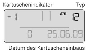
Links oben wird der Indikator für die Filterkartusche (-1 für vorletzte Filterkartusche) im Wechsel mit der dabei eingestellten Karbonathärte zusammen mit der Härteeinheit angezeigt. Rechts oben wird die Filtersystemgröße im Wechsel mit der Verschnitteinstellung (Darstellung 1 s Indikator, 1 s Karbonathärte), links unten der Zählerstand beim Austausch der Kartusche (-1) und rechts unten das Einbaudatum der Kartusche dargestellt.
